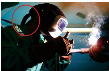
Un respirador protege a este soldador—la manguera del respirador está señalada con un círculo rojo.
