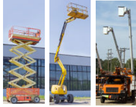
Un elevador de tijera (izquierda), un camión grúa de carga (en el centro), y una plataforma hidráulica (derecho).
