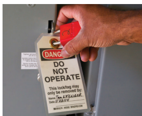
Una máquina bloqueada y etiquetada.
