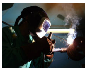
Un respirador con suministro de aire brinda un nivel alto de protección
