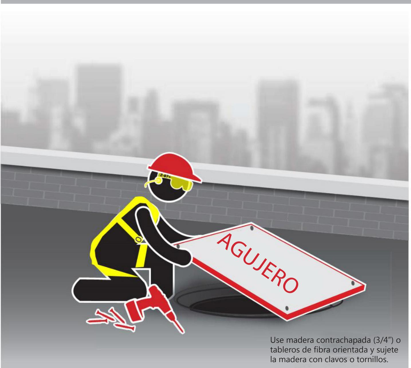
Use madera contrachapada (3/4") o tableros de fibra orientada y sujete la madera con clavos o tornillos.
