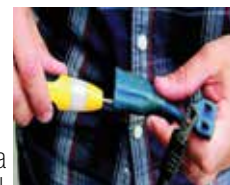
Persona competente poniendo una extensión de cable a prueba.
