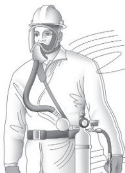
Respirador con suministro de aire (Supplied-Air Respirator, SAR) de máscara completa con un contenedor de escape auxiliar
