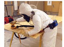
Foto: Trabajador con el equipo de protección completo realizando pruebas para CPWR dentro de una recámara especial utilizando un sistema de recolección de polvo
